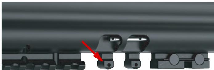
4. Переустановить СК и предохранитель ближе к дульному срезу. Зацепить тягу за СК. Установить фиксирующий штифт.
